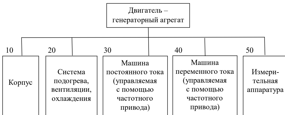
Рисунок 3.3. Диаграмма подсистем двигателя-генератора
