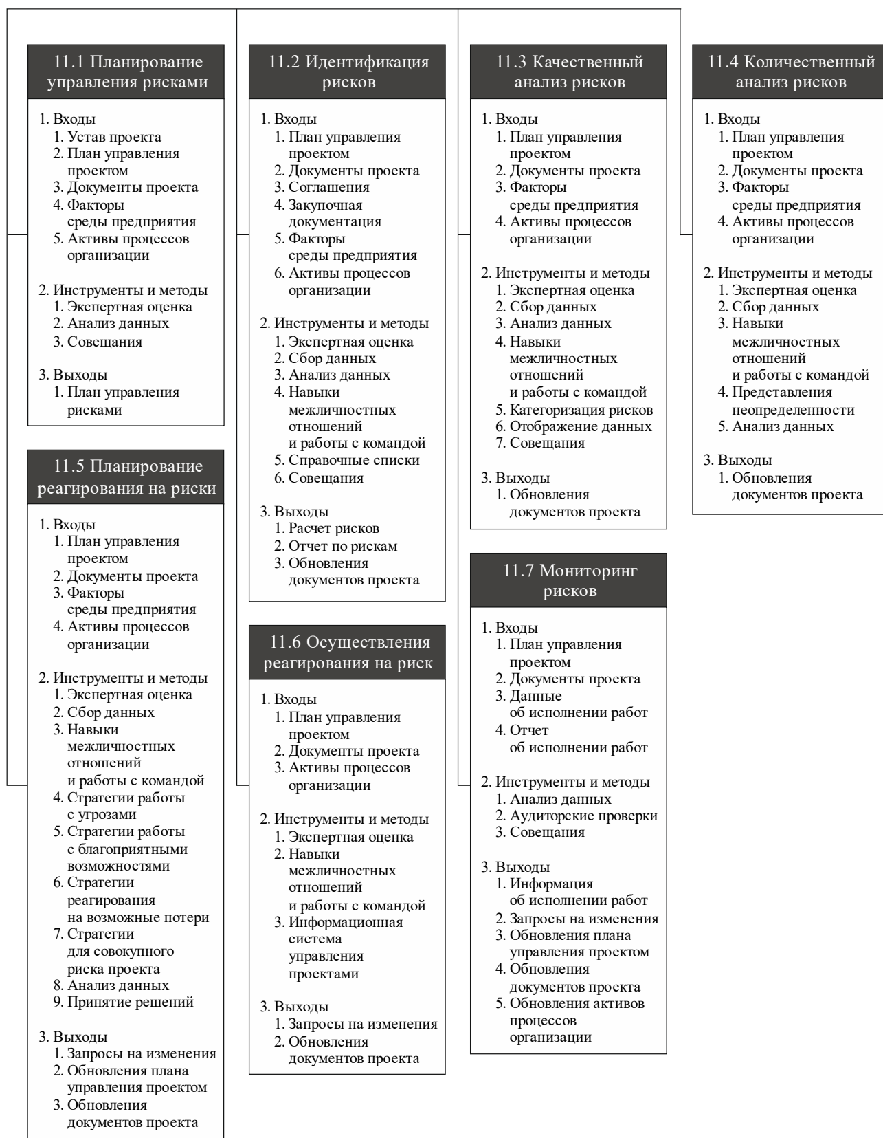
Рис. 5.2 – Общая схема управления рисками проекта по PMBoK
